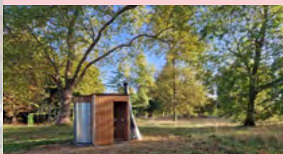
**Les toilettes sèches sont écologiques et économiques.** L'appareil fonctionne par la seule énergie du vent et du soleil, sans eau, sans électricité et sans produits chimiques. Tout d'abord, les solides et les liquides sont séparés. Un courant d'air continu évapore partiellement les liquides et déshydrate les matières solides.
